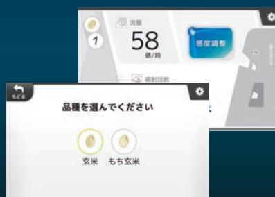
選別設定を行う異物をイラストで表示するなど、感度調整が直感的に行えるよう操作画面の設計を見直しました。
